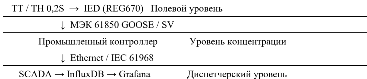
Рисунок 1. Трёхуровневая архитектура системы мониторинга реактивной мощности. Сравнительный анализ методов компенсации реактивной мощности. Эффективность системы мониторинга реализуется в полной мере лишь при тесном сопряжении с
