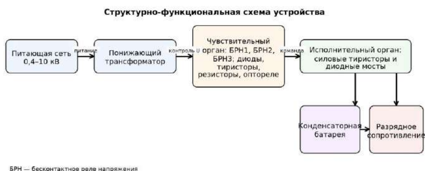
Рис. 1. Структурно-функциональная схема устройства автоматической коммутации конденсаторной батареи
